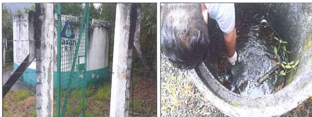
Figura 05: Coleta de amostra de água tratada próxima ao Reservatório R01
