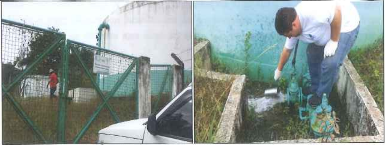
Figura 06: Coleta de amostra de água tratada no Reservatório R03
