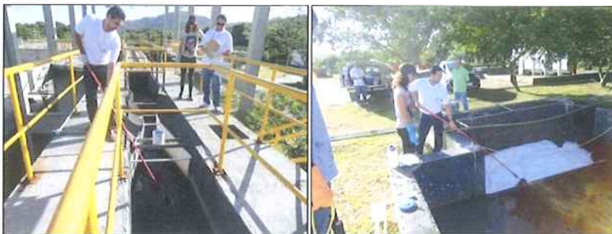
Figura 4: Coleta de amostra dos efluentes bruto e final da ETE Canasvieiras (22/01/2016)
