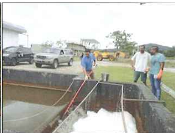
Figura 9: Coleta de amostra dos efluentes bruto e final da ETE Canasvieiras (27/01/2016)
