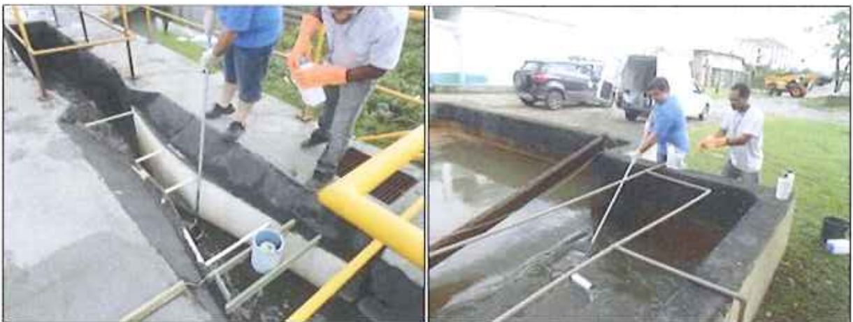
Figura 11: Coleta de amostra dos efluentes bruto e final da ETE Canasvieiras (29/01/2016)
