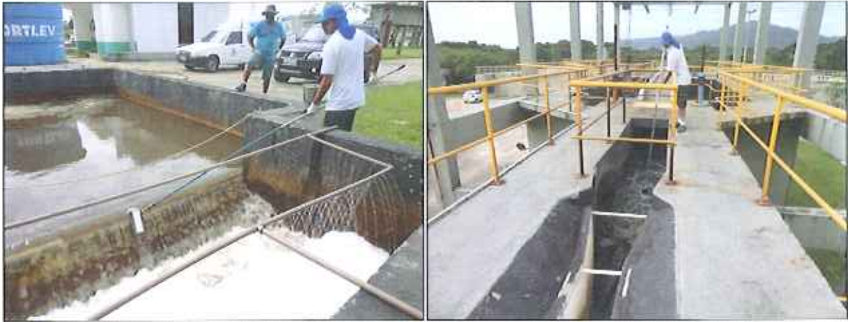
Figura 22: Coleta de amostra dos efluentes bruto e final da ETE Canasvieiras (09/02/2016)
