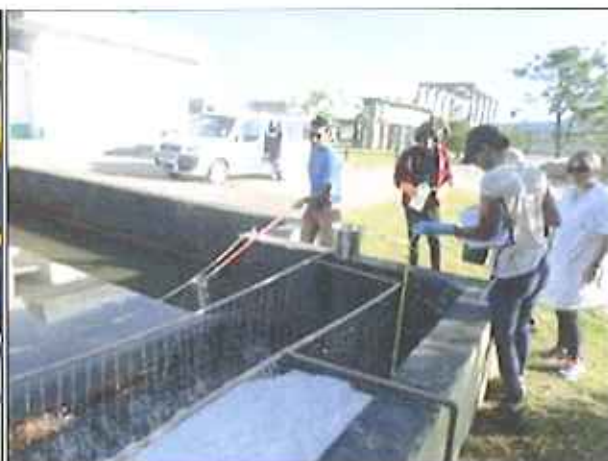
Figura 8: Coleta de amostra dos efluentes bruto e final da ETE Canasvieiras (26/01/2016)
