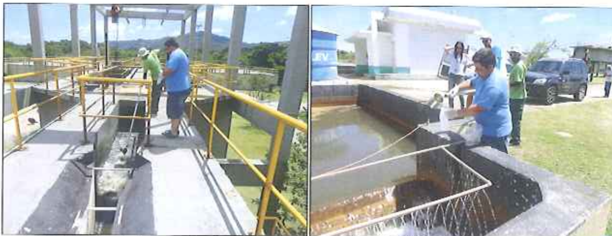
Figura 25: Coleta de amostra dos efluentes bruto e final da ETE Canasvieiras (12/02/2016)
