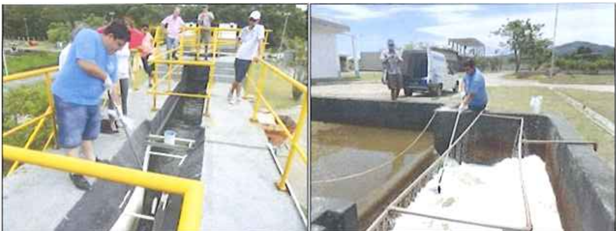
Figura 3: Coleta de amostra dos efluentes bruto e final da ETE Canasvieiras (21/01/2016)
