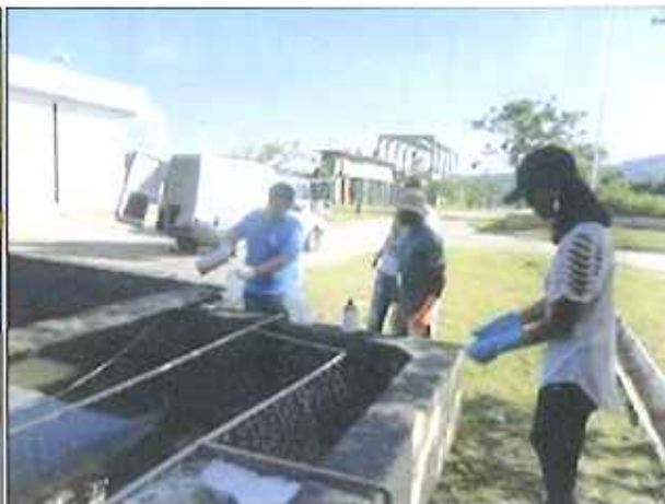
Figura 7: Coleta de amostra dos efluentes bruto e final da ETE Canasvieiras (25/01/2016)
