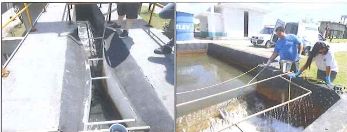
Figura 32: Coleta de amostra dos efluentes bruto e final da ETE Canasvieiras (19/02/2016)
