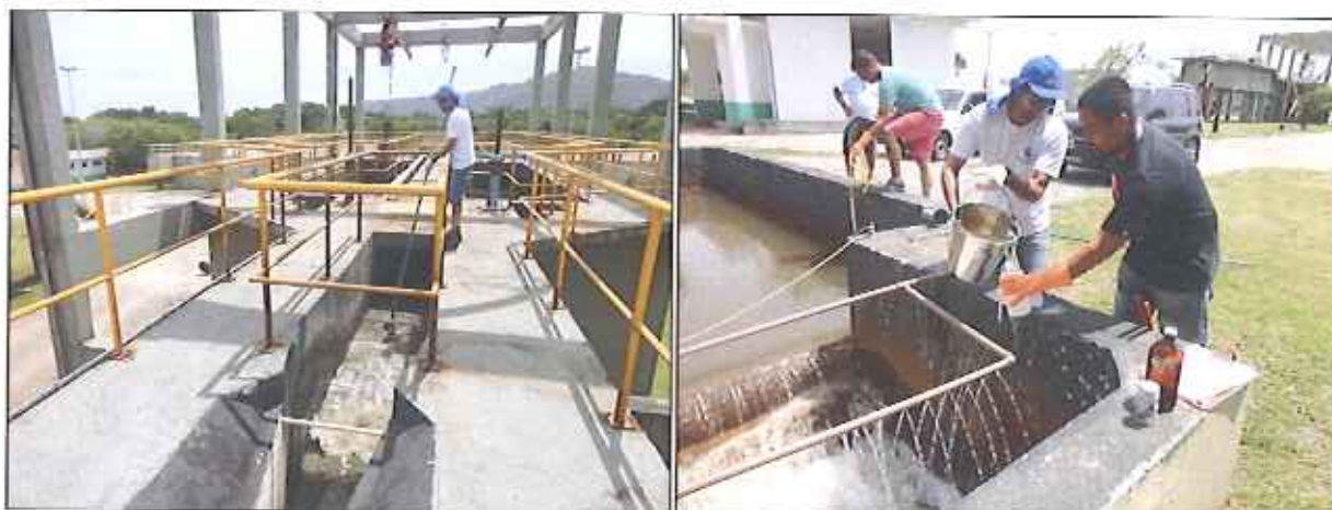
Figura 27: Coleta de amostra dos efluentes bruto e final da ETE Canasvieiras (14/02/2016)
