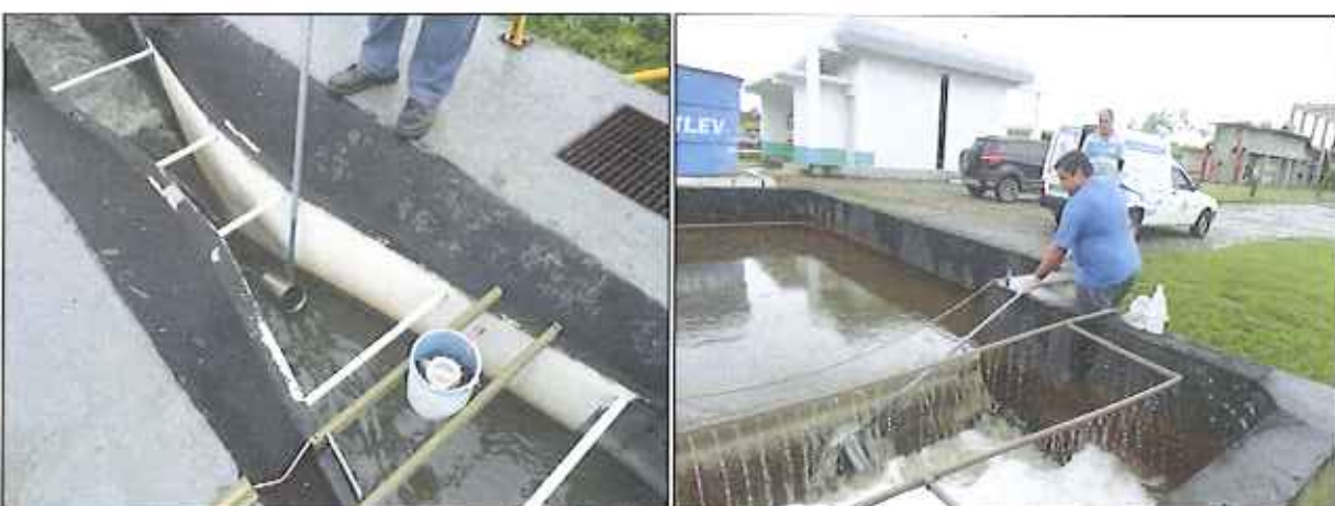
Figura 15: Coleta de amostra dos efluentes bruto e final da ETE Canasvieiras (02/02/2016)
