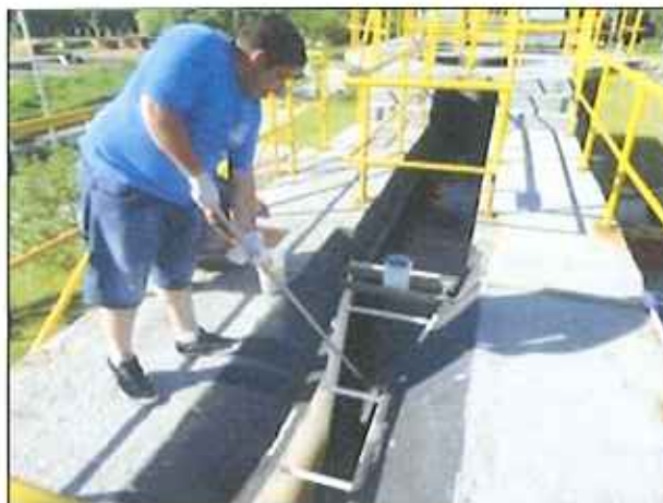
Figura 7: Coleta de amostra dos efluentes bruto e final da ETE Canasvieiras (25/01/2016)
