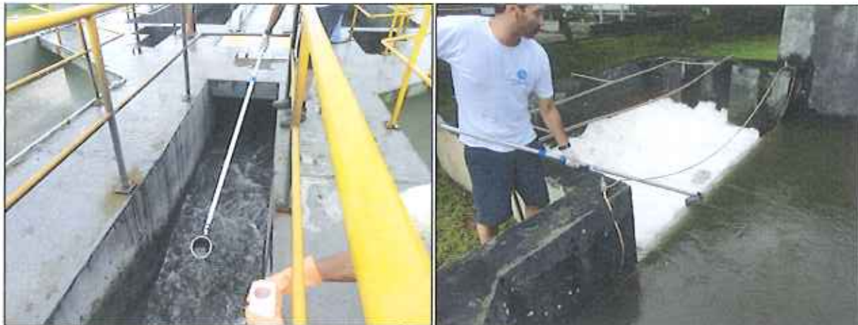
Figura 13: Coleta de amostra dos efluentes bruto e final da ETE Canasvieiras (31/01/2016)
