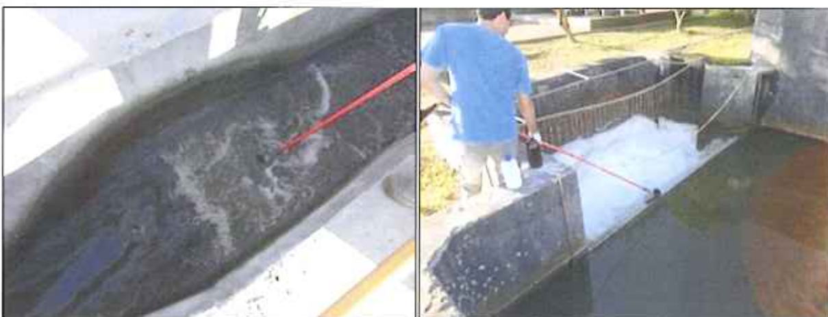
Figura 6: Coleta de amostra dos efluentes bruto e final da ETE Canasvieiras (24/01/2016)
