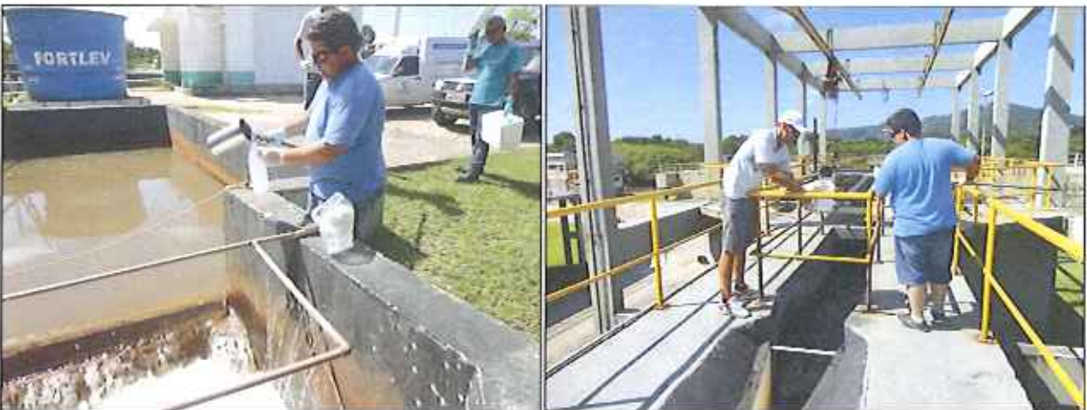
Figura 21: Coleta de amostra dos efluentes bruto e final da ETE Canasvieiras (08/02/2016)
