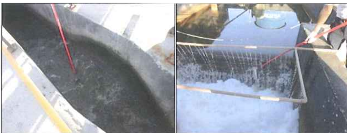
Figura 5: Coleta de amostra dos efluentes bruto e final da ETE Canasvieiras (23/01/2016)
