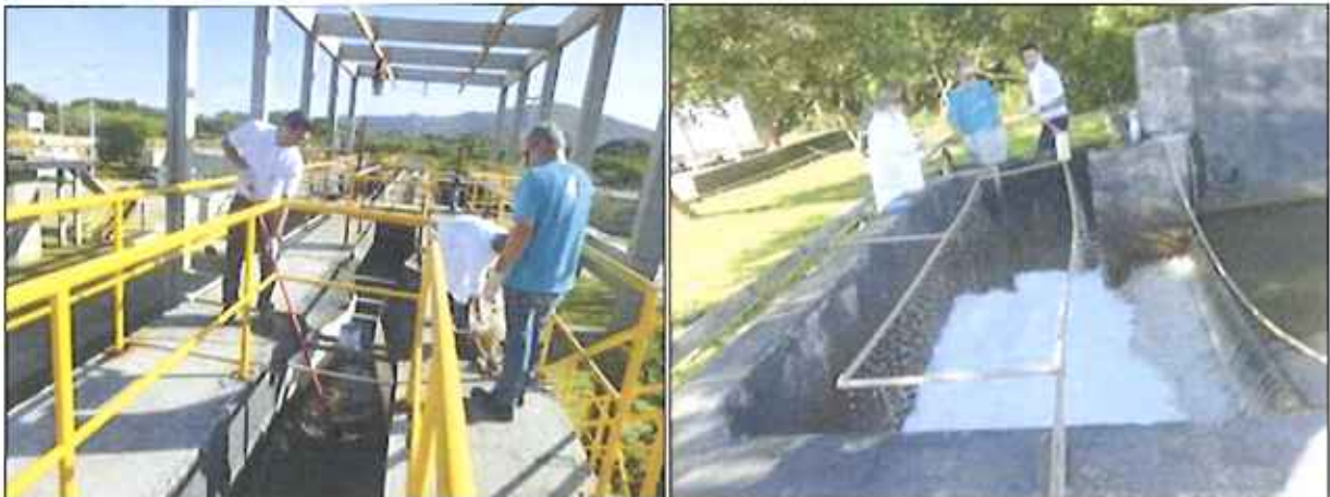
Figura 2: Coleta de amostra dos efluentes bruto e final da ETE Canasvieiras (20/01/2016)
