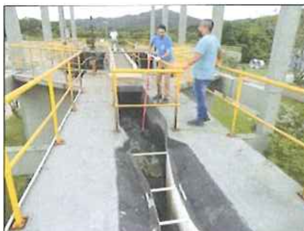
Figura 9: Coleta de amostra dos efluentes bruto e final da ETE Canasvieiras (27/01/2016)
