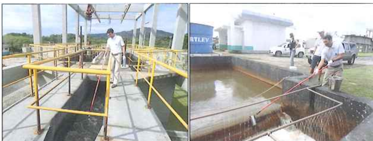
Figura 17: Coleta de amostra dos efluentes bruto e final da ETE Canasvieiras (04/02/2016)
