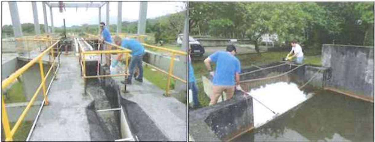
Figura 10: Coleta de amostra dos efluentes bruto e final da ETE Canasvieiras (28/01/2016)
