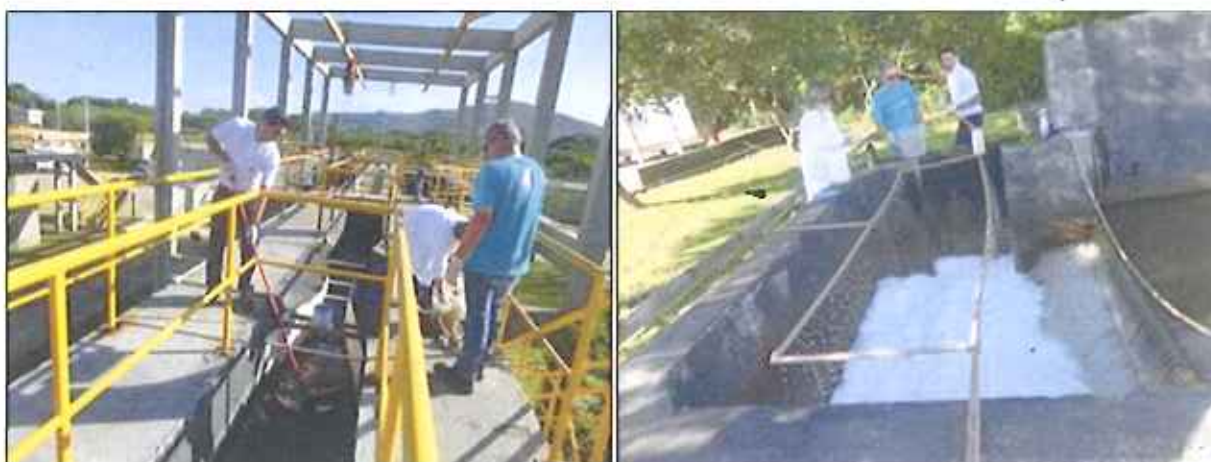
Figura 1: Coleta de amostra dos efluentes bruto e final da ETE Canasvieiras (20/01/2016)
