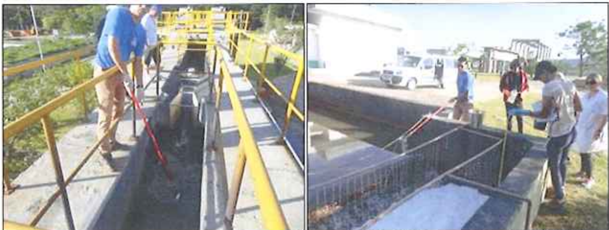
Figura 7: Coleta de amostra dos efluentes bruto e final da ETE Canasvieiras (26/01/2016)
