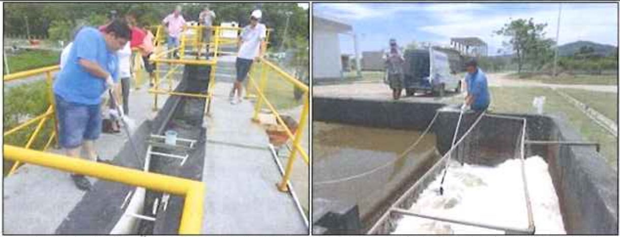
Figura 2: Coleta de amostra dos efluentes bruto e final da ETE Canasvieiras (21/01/2016)
