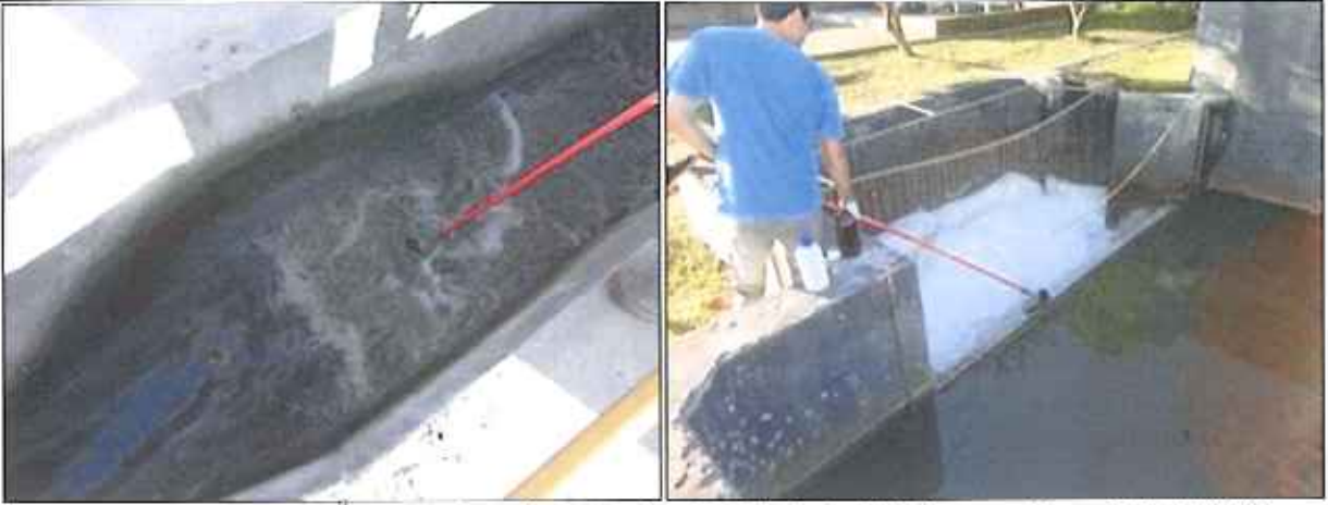
Figura 5: Coleta de amostra dos efluentes bruto e final da ETE Canasvieiras (24/01/2016)
