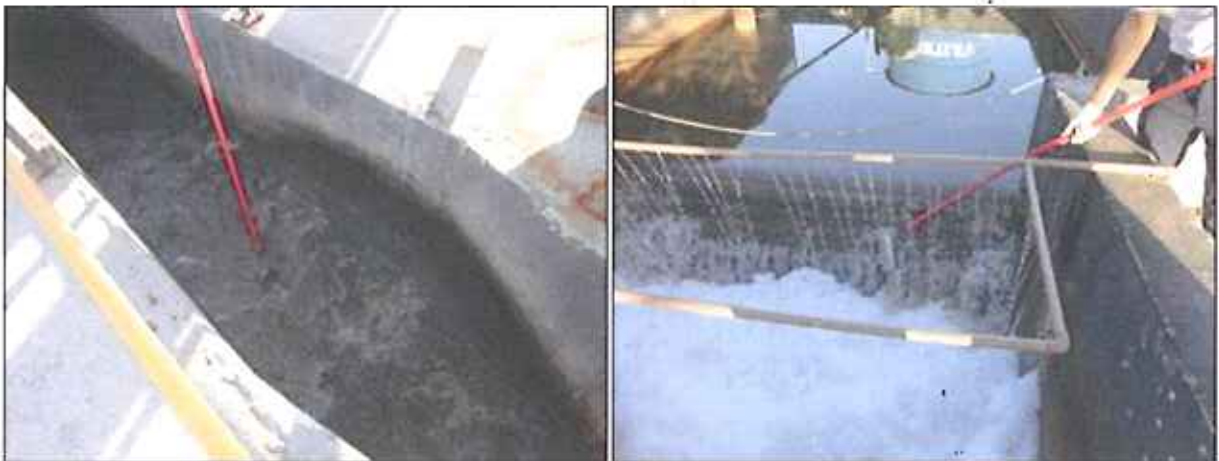
Figura 4: Coleta de amostra dos efluentes bruto e final da ETE Canasvieiras (23/01/2016)
