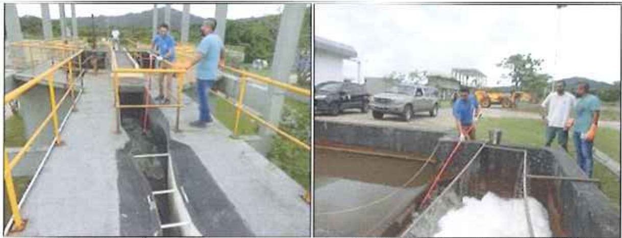
Figura 8: Coleta de amostra dos efluentes bruto e final da ETE Canasvieiras (27/01/2016)
