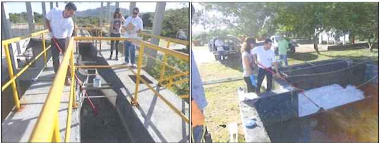
Figura 3: Coleta de amostra dos efluentes bruto e final da ETE Canasvieiras (22/01/2016)
