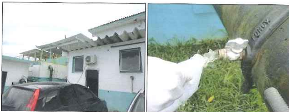
Figura 2: Coleta de amostra de água bruta nas tubulações da ETA Porto Belo (Rio Perequê)
