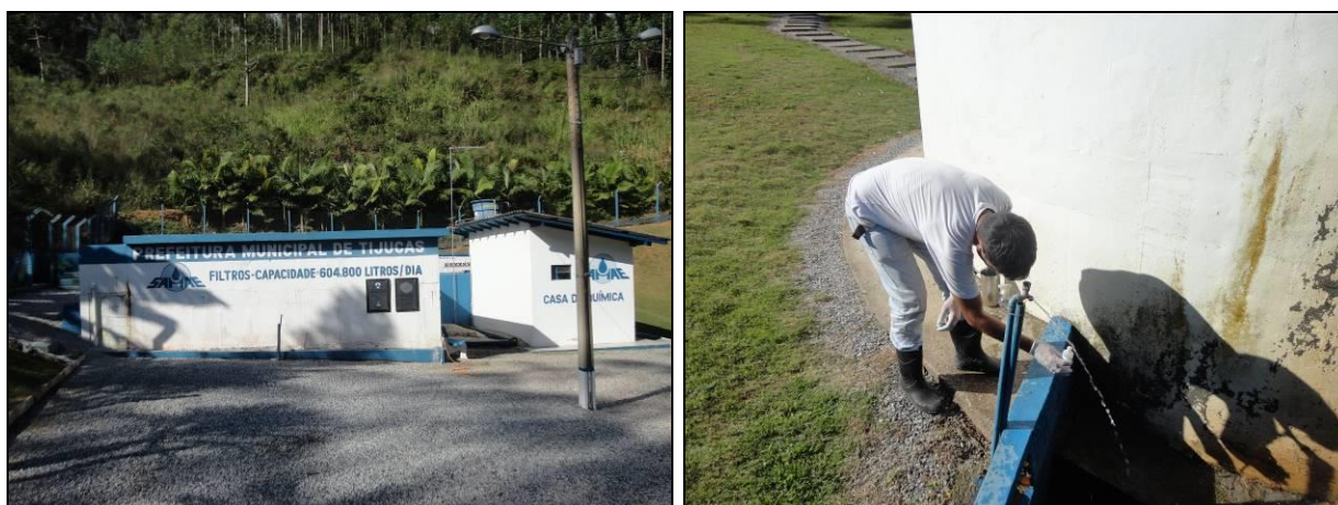
Figura 3: Coleta de água na ETA Oliveira (10/06/2015)
