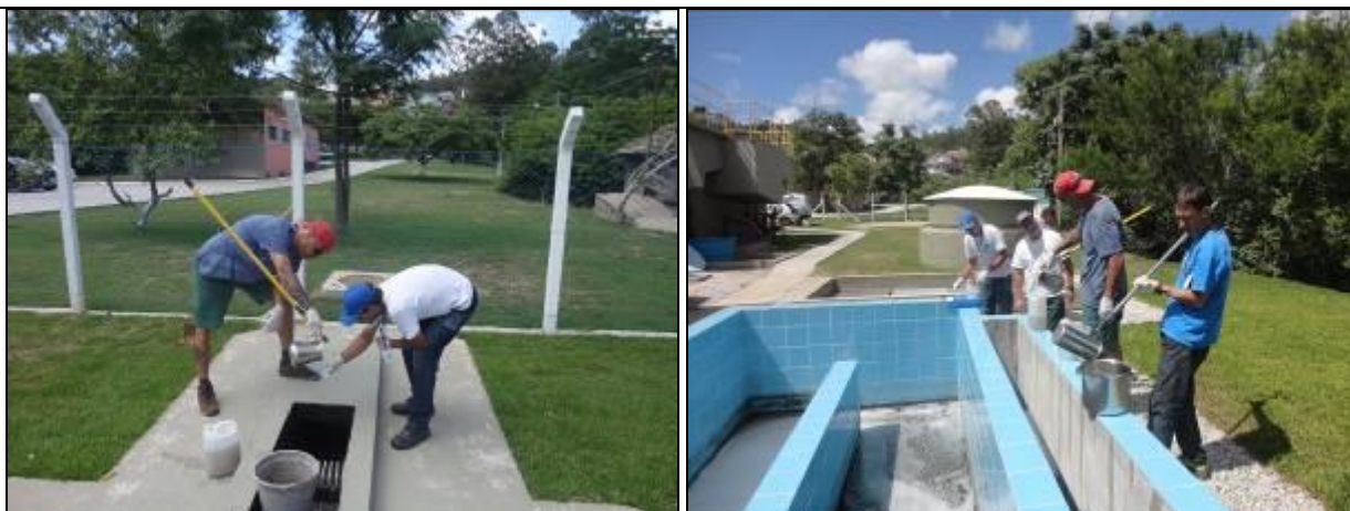
Figura 50: Coleta de amostras do efluente bruto e efluente final da ETE Saco Grande (05/12/2014)
