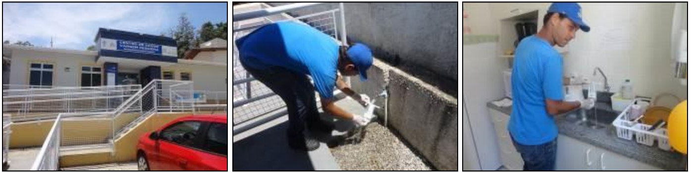
Figura 40: Coleta de amostras de água da Rede de distribuição na Vargem Pequena (03/12/2014)
