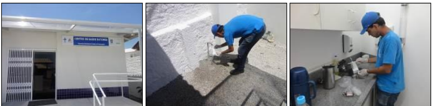
Figura 43: Coleta de amostras de água da Rede de distribuição no Ratones (03/12/2014)
