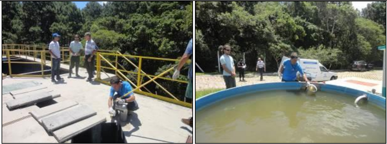
Figura 52: Coleta de amostras do efluente bruto e efluente final da ETE Barra da Lagoa (05/12/2014)
