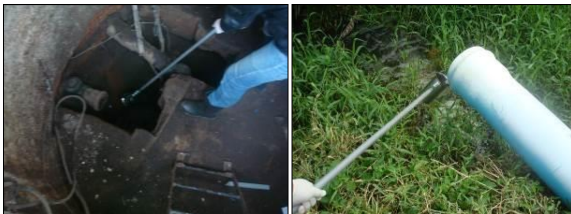
Figura 56: Coleta de amostras de esgoto do efluente bruto e efluente final da ETE Praia Brava (18/06/2014)
