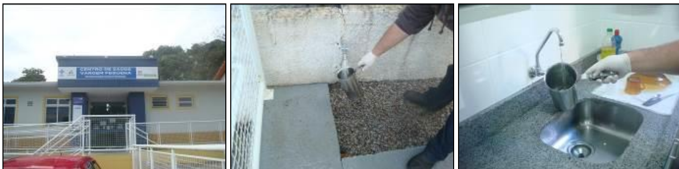
Figura 39: Coleta de amostras de água da Rede de distribuição na Vargem Pequena (25/06/2014)
