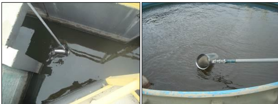
Figura 54: Coleta de amostras de esgoto do efluente bruto e efluente final da ETE Barra da Lagoa (18/06/2014)
