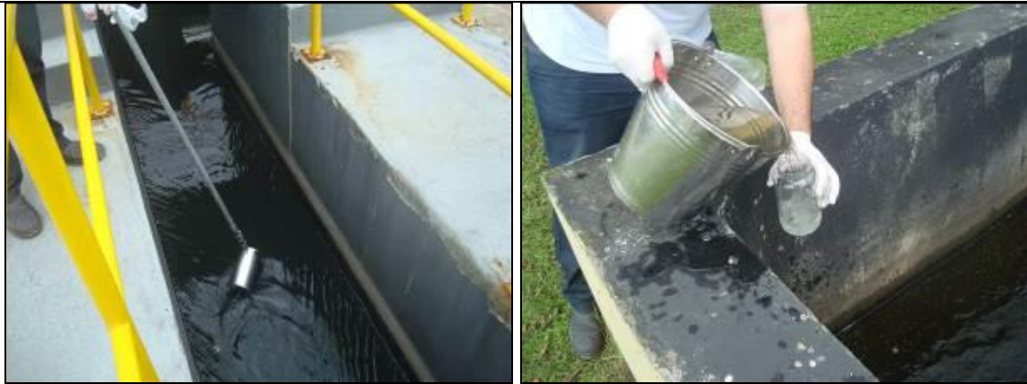
Figura 58: Coleta de amostras de esgoto do efluente bruto e efluente final da ETE Canasvieiras (18/06/2014)
