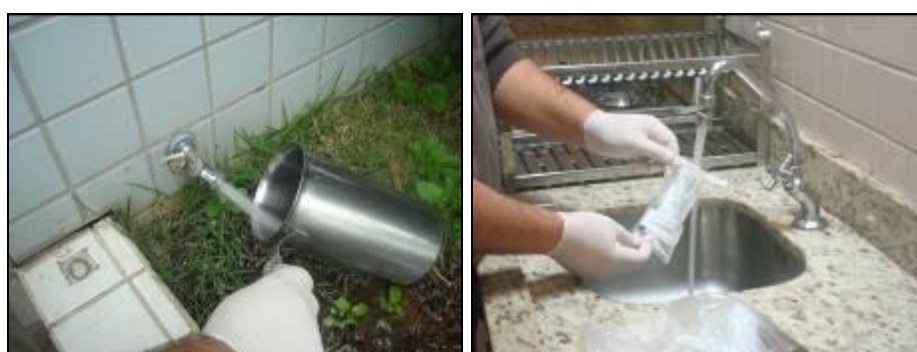
Figura 23: Coleta de amostras de água da Rede de distribuição na Agronômica (25/06/2014)
