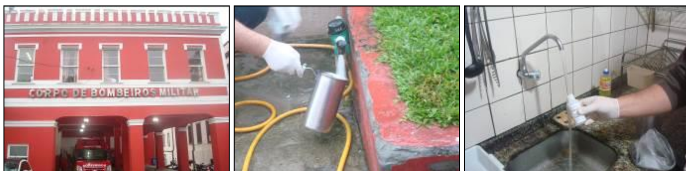
Figura 24: Coleta de amostras de água da Rede de distribuição no Centro (25/06/2014)
