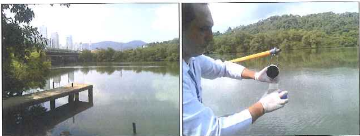
Figura 04: Coleta de amostra de água do Rio Camboriú, no ponto a montante do lançamento do efluente tratado da ETE
