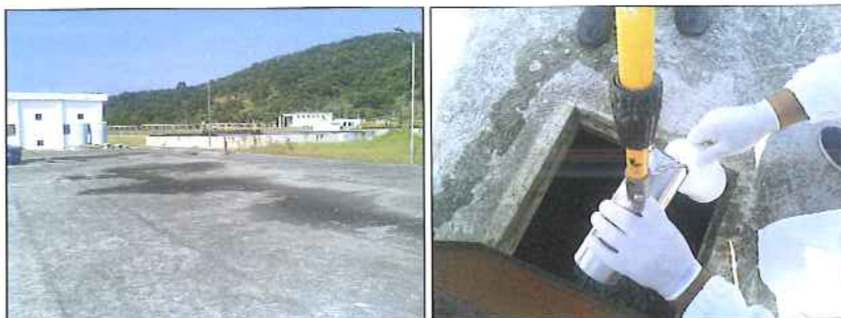
Figura 02: Coleta de amostra de efluente tratado no tanque de contato da ETE
