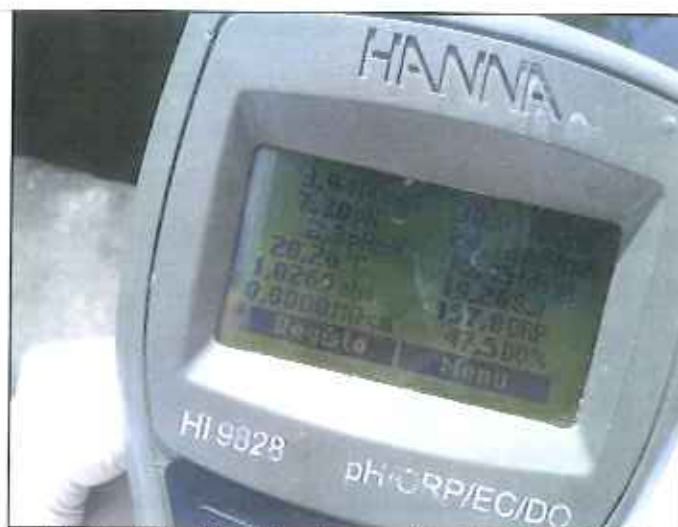
Figura 05: Medida do parâmetro Salinidade durante a coleta de amostra no ponto a montante da zona de mistura.
