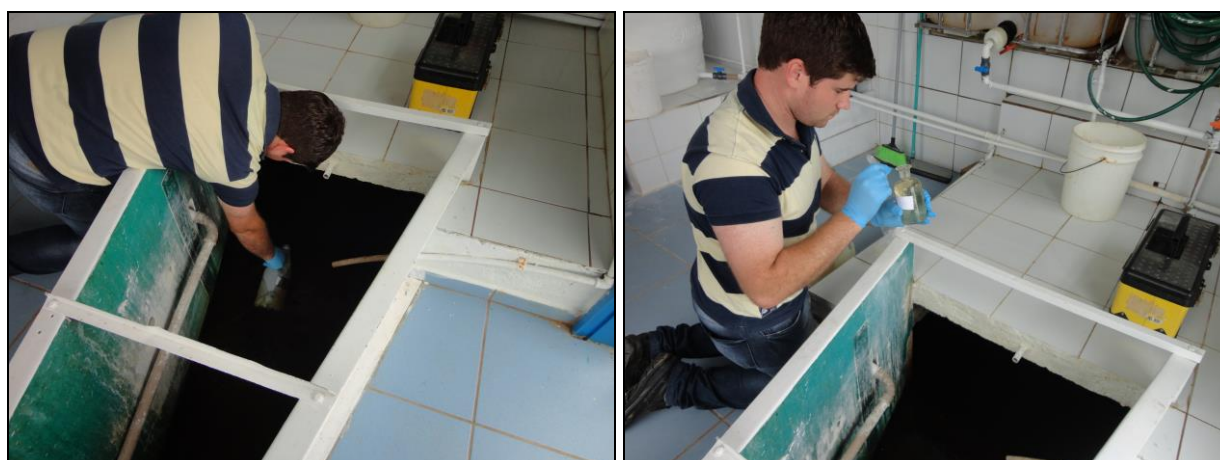
Figura 1: Coleta de amostra de água bruta na calha da ETA
