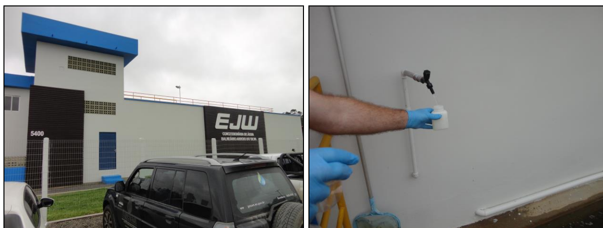
Figura 2: Coleta de amostra de água tratada na saída da ETA
