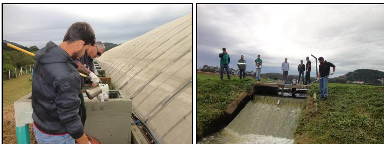
Figura 15: Coleta de amostras do efluente bruto e efluente tratado da ETE Potecas (11/06/2015)
