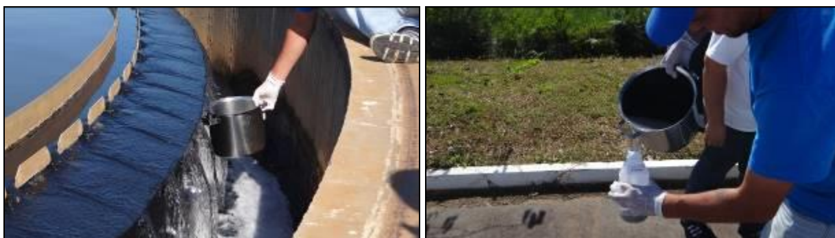
Figura 20: Coleta de amostra de efluente tratado na ETE
