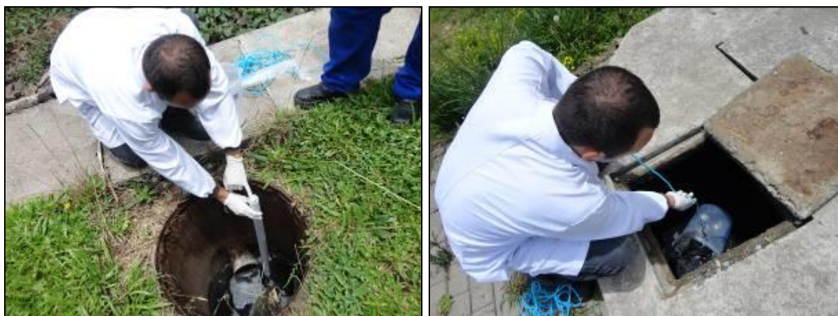
Figura 23: Coleta de amostra de efluentes bruto e final na ETE Lourival Bet
