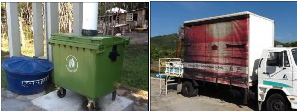
Figura 112- Caixa receptora de sólidos gradeados e caminhão desidratador de lodo (Inicial)
