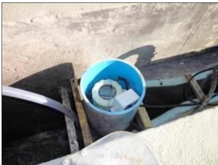
Figura 35- Medidor de vazão (Acompanhamento)
