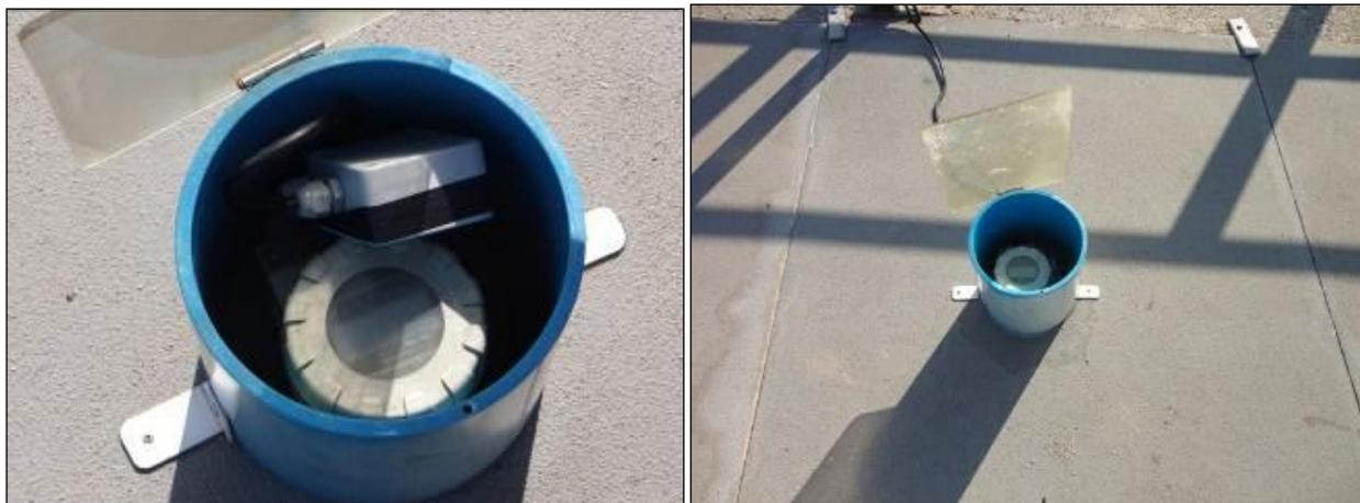
Figura 13 - Medidor de Vazão (Inicial) e Medidor de vazão (Acompanhamento)
