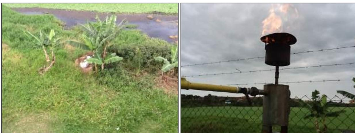
**Figura 29: Entorno (esquerda) e queimador de metano à direita (antes).**
