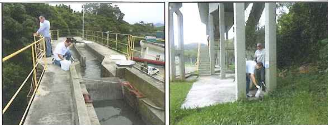
Figura 50: Coleta de amostras dos efluentes bruto e final da ETE Lagoa da Conceição (30/11/2015)
