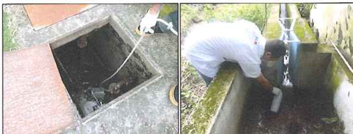
Figura 48: Coleta de amostras dos efluentes bruto e final da ETE Parque Tecnológico (30/11/2015)
