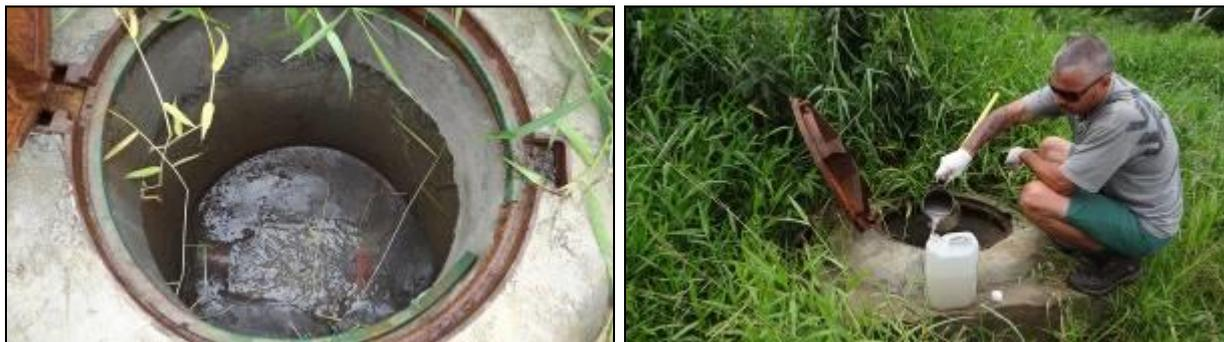
Figura 13: Coleta de amostra de efluente bruto na ETE
