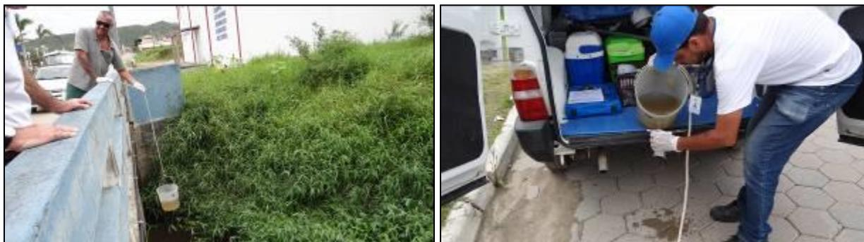
Figura 14: Coleta de amostra de efluente tratado na ETE
