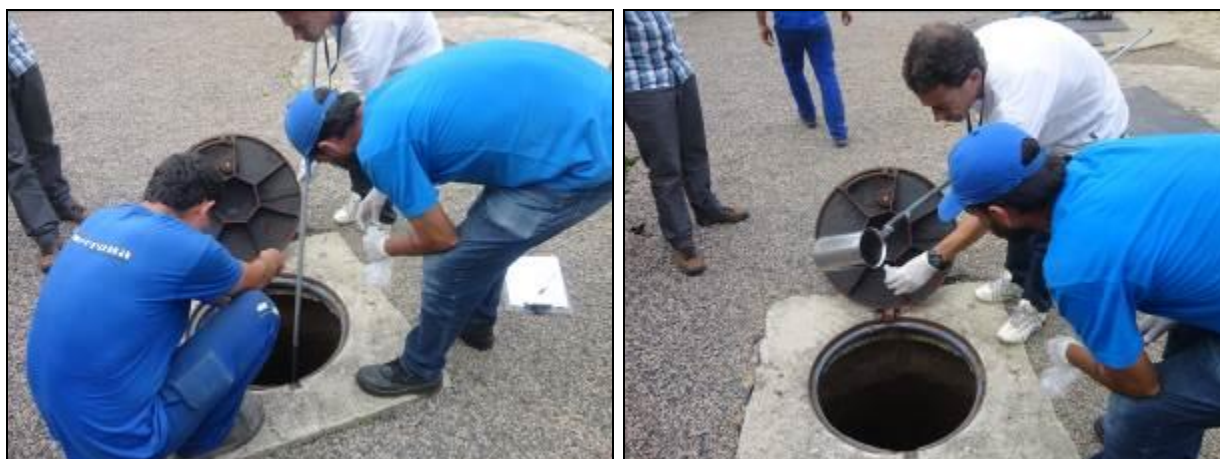
Figura 17: Coleta de amostra de efluente bruto da ETE
