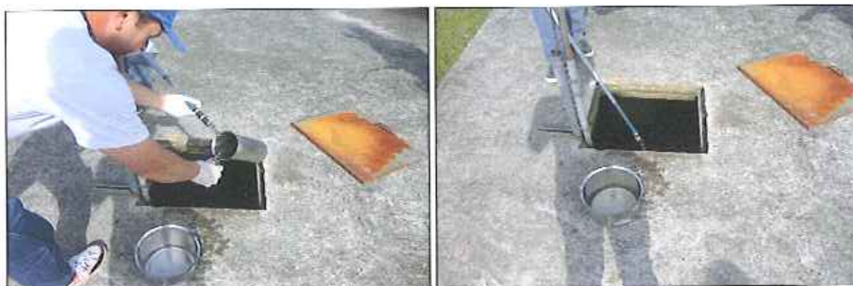
Figura 18: Coleta de amostra de efluente tratado na ETE
