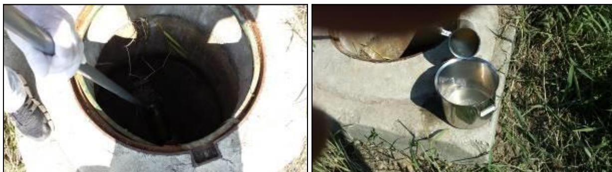
**Figura 13: Coleta de amostra de efluente tratado da ETE**
