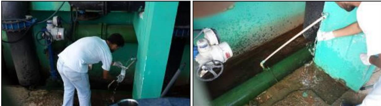
Figura 2: Coleta de amostra de água bruta nas tubulações da ETA Porto Belo
