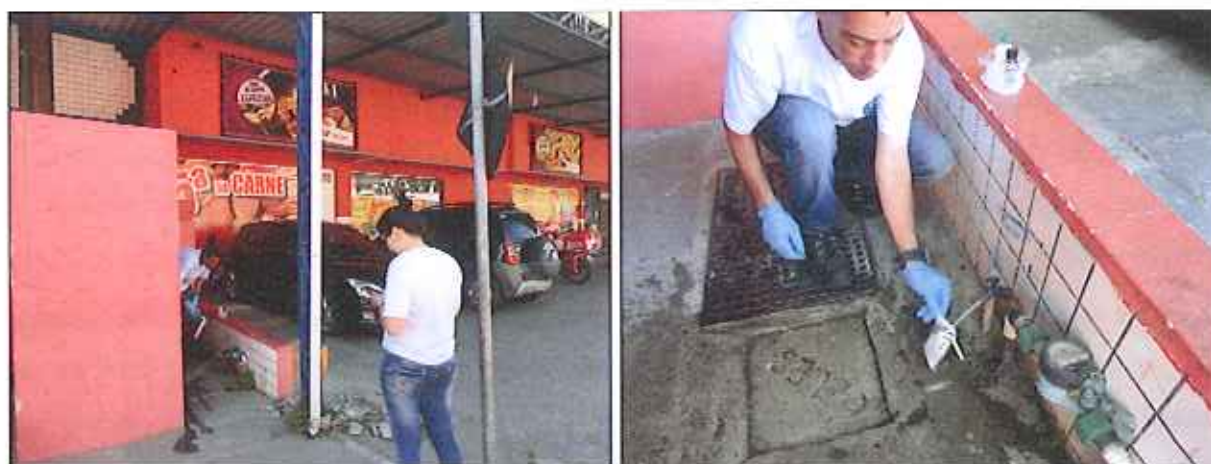
Figura 8: Coleta de amostras de água da Rede de distribuição no Mercado do bairro Forquilhas
