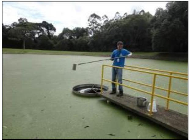
**Figura 2: Coleta de amostra do efluente tratado da Estação (30/05/2014)**
